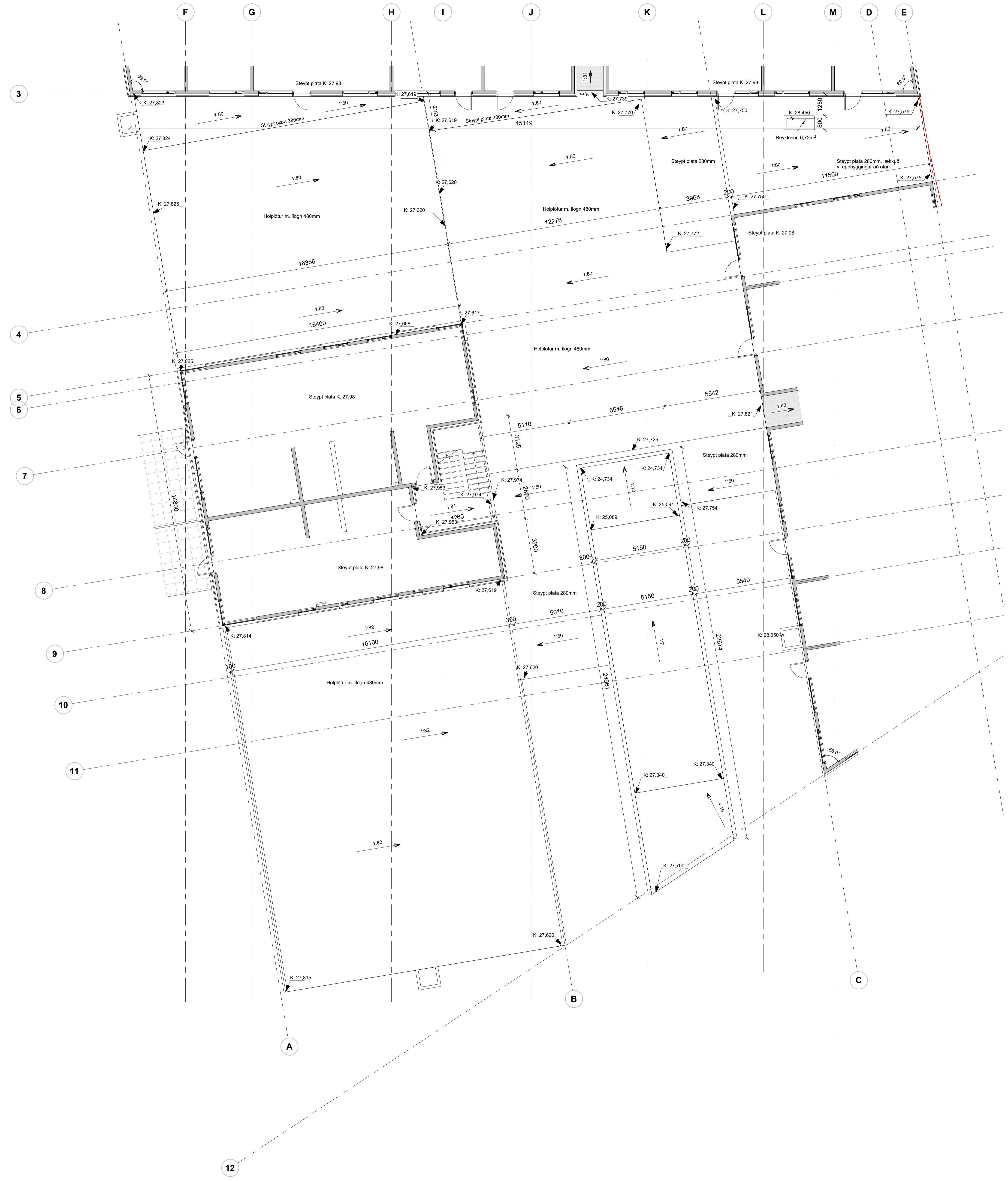
01-Hæð 1 - Steyputeikningar Hallaplan plötu yfir bilakj. 1:100
